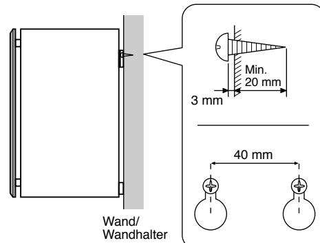
Sie können für das Montieren des Lautsprechers mit Hilfe einer im Handel erhältlichen Lautsprecher-Halterung auch die Schraubenlöcher auf der Rückseite des Lautsprechers verwenden (falls Sie nicht die beiliegende Montagehalterung verwenden).
