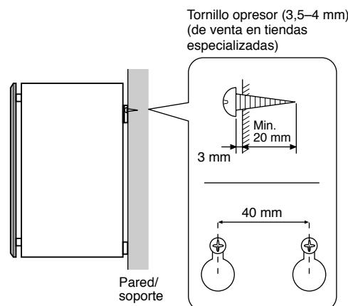
Se pueden utilizar también los agujeros de tornillo en la parte trasera del altavoz para la instalación de este mediante el uso de un soporte de altavoz de los disponibles en el mercado (en caso de que no utilice el soporte de montaje incluido).
