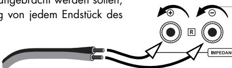
Drehen Sie den Knopf nun im Uhrzeigersinn, um den Draht in der Lautsprecherklemme festzuklemmen. Achten Sie darauf, dass die Verschraubung fest ist.
