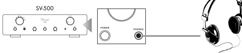
Dadurch werden die Lautsprecher abgeschaltet. Es können alle Kopfhörer mit einer Impedanz zwischen 32 Ohm und 600 Ohm verwendet werden. Ungeeignete Kopfhörer mit zu niedriger Impedanz können den Verstärker beschädigen oder unerwartet eine so hohe Lautstärke produzieren, dass Ihr Gehör geschädigt werden kann. Vor dem Einsticken sollte vorsichtshalber die Lautstärke am Drehknopf bzw. an den Tasten „VOLUME“ (8)(21) reduziert werden.
