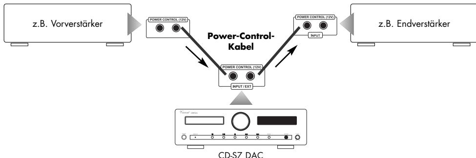
Durch ein sendendes Gerät können theoretisch unendlich viele Geräte mit den Schaltimpulsen versorgt werden. Zu diesem Zweck kann an den meisten Geräten einer der beiden „POWER CONTROL“-Anschlüsse als Signaleingang und der andere als Signalausgang verwendet werden. Diese Methode, das Signal durch Ein- und Ausgänge der Geräte durchzuschleifen und diese somit zu verketten, wird auch als
