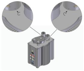
Abschließend die Erdungsschrauben einsetzen und fest anziehen.
