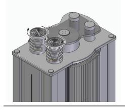
Schrauben Sie die Röhrenabdeckung im Urzeigersinn fest.
