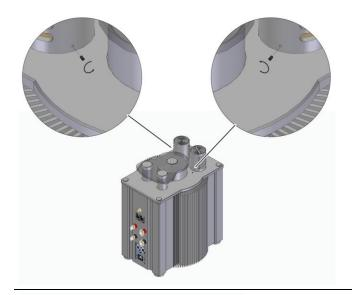
Erdungsschrauben mit Hilfe des beiligenden Inbusschlüssels entfernen.
