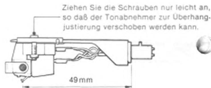
❸ Schieben Sie den Tonarmkopf auf den Tonarm auf, wobei Sie den Führungsstift des Tonarmkopfes in den Schlitz oben im Tonarm einpassen.
