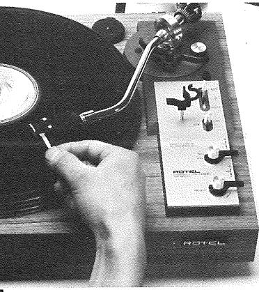
tourner. Tirer le levier de repérage en avant sur DOWN pour abaisser le bras acoustique sur le disque et pour commencer l'enregistrement.
