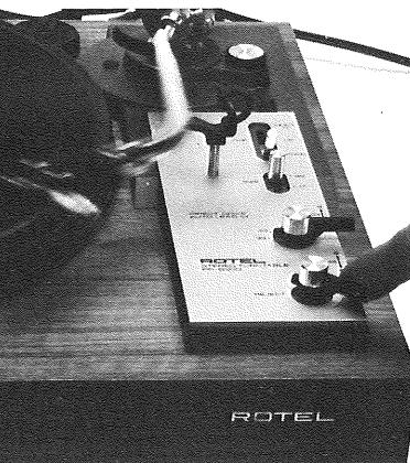
**J** 演奏の途中でカットさせたいときはリジェクトレバーを矢印方向へ動かしてください。トーンアームはその時点で自動的にアームレストに復帰し電源スイッチもカットされます。
