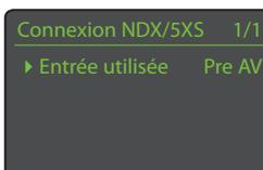
La sélection de **Lecteur CD** ouvre un menu qui rend disponible la commande du transport des CD à travers l'interface n-Stream du NDX/5XS. Sélectionnez **Activé** pour activer la commande du CD et sélectionnez **Entrée utilisée** pour spécifier l'entrée du NDX/5XS, du préamplificateur ou du DAC à laquelle le lecteur CD est connecté.
