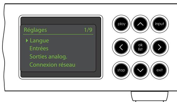
On entre en mode réglages en appuyant sur la touche **réglages** (⚙) de la télécommande ou en appuyant et maintenant enfoncé le bouton **ok/list** de la façade. Vous aurez ainsi accès à toutes les fonctions de réglage du NDX/5XS.
