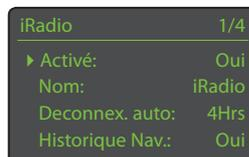
**Deconnex. auto:** Sélectionner le temps. Déconnexion auto est proposée afin que la limite de transfert de données imposée par le fournisseur internet ne soit pas dépassée par inadvertance, en laissant le NDX/5XS connecté à la radio internet.
