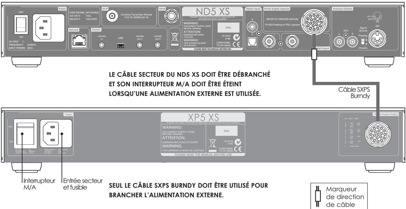
**Note :** La connexion d'une alimentation XPS est réalisée exactement de la même manière que le raccordement d'une alimentation XP5 XS.
