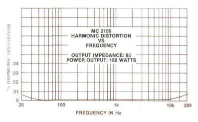
PERFORMANCE CHARTS ARE FOR ONE STEREO CHANNEL WITH BOTH CHANNELS OPERATING. MONO OPERATION IS IDENTICAL EXCEPT POWER IS DOUBLED FOR THE SINGLE MONO OUTPUT.
