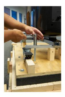
11. REMOVE CHOCK BLOCKS FROM BEHIND THE CASTER WHEELS AND FROM UNDERNEATH SHIPPING BAR.
