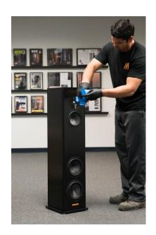
**13.** ADJUST THE SPIKES BY THREADING/UNTHREADING THEM TO LEVEL THE SPEAKER AND TIGHTEN THE LOCK NUT AGAINST THE PUCK TO LOCK THE SPIKE IN POSITION.
