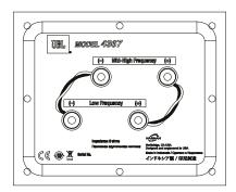
Vi har designet 4367, således at en positiv spænding ved "+"-terminalen (rød) får højttalertransducerne til at bevæge sig udad (i retning mod lokalet).
