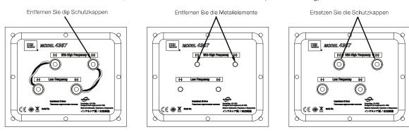
Wenn Sie den Lautsprecher mit einen einzelnen Stereo-Verstärker zweifach verbinden, so schließen Sie ihn an wie in der folgenden Abbildung dargestellt.
