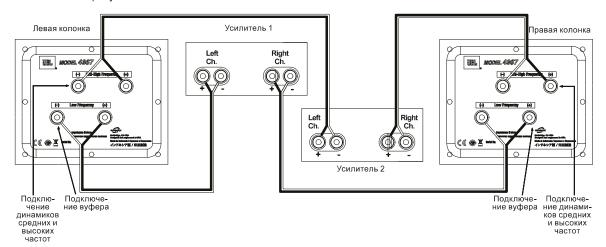
В любом случае следует выполнять инструкции для различных типов соединителей в разделе «Основное однопроводное подключение» на стр. 4.
