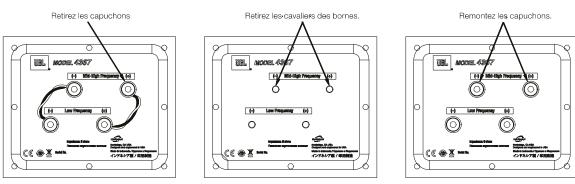
Si vous utilisez un bicâblage avec un seul amplificateur de puissance stéréo, branchez les enceintes selon l'illustration suivante.
