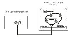
BEMÆRK: Undgå at oprette tilslutninger med omvendt polaritet (dvs. "+" til "-" eller "-" til "+"). I modsat fald vil der opstå forringet stereobillede og basgengivelse.
