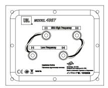
A 4367 foi projetada para que uma voltagem positiva no terminal "+" (vermelho) mova os transdutores dos falantes para a frente (em direção ao ambiente).
