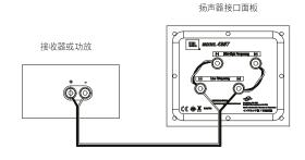
重要信息:连接时,请勿错接极性(将 "+" 连接至 "-",反之亦然)。否则,会导致立体声声场成像质量下降和低音减弱。
