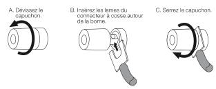
IMPORTANT: veillez à ce que les cosses des connecteurs (+) et (-) ne se touchent pas et ne touchent pas l'autre borne. Un contact des cosses peut créer un court-circuit et endommager votre récepteur ou amplificateur.
