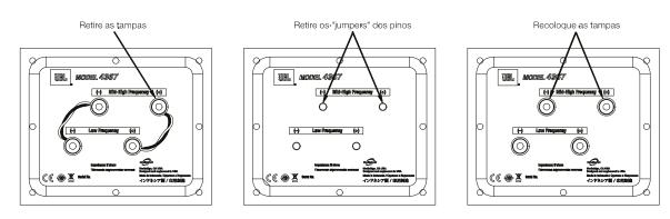
Se conectar a caixa a um amplificador de potência estéreo usando dois fios, ligue-as de acordo com a ilustração abaixo.
