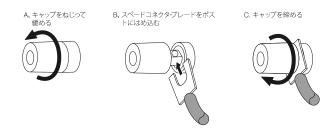
重要: (+)と(-)のスペードコネクタ・ブレードが互いに、あるいは他の端子と接触していないことを確認してください。ブレード に触れると回路がショートし、レシーバーまたはアンプが破損する可能性があります。
