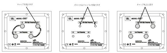
シングルステレオ・パワーアンプとバイワイヤリングさせる場合は、下のイラストの通りにスピーカーを接続してください。
