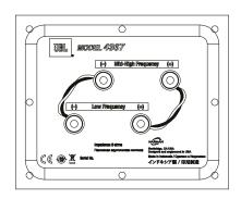
4367は、「+」(赤色)端子の陽電極の電圧がスピーカーのトランスデューサーを外向きに(部屋に向かって)動かすように設計されています。
