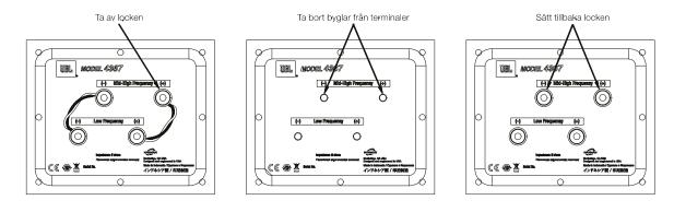
Om du dubbelkabelansluter till en enda stereoeffektförstärkare ska högtalarna anslutas enligt följande bild.
