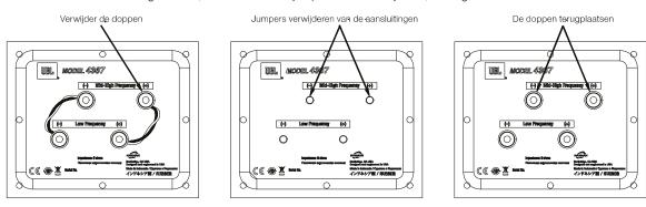
Als je bi-wiring gebruikt met een enkele stereo eindversterker, de luidsprekers aansluiting volgens onderstaande afbeelding.
