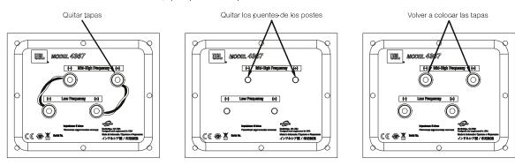
Si va a usar doble cableado con un solo amplificador estéreo, conecte los altavoces según la ilustración siguiente.
