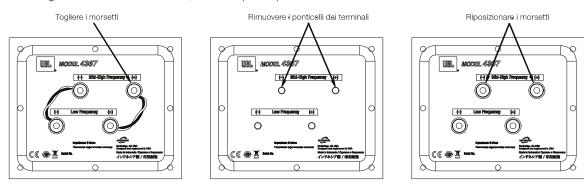
Se state collegando in modalità bi-wire un singolo amplificatore stereo, collegate gli altoparlanti secondo la seguente illustrazione.
