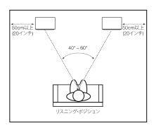
最高のパフォーマンスを得るには、スピーカーを約2~3m(約6~10フィート)離して設置してください。スピーカーをもっと離して設置する場合は、リスニング・ポジションの方に向けて角度を変えてください。
