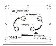
El 4367 se ha diseñado de tal modo que una tensión positiva en el terminal "+" (rojo) desplace los transductores del altavoz hacia fuera (hacia la sala).
