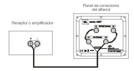
IMPORTANTE: No invierta las polaridades (esto es, "+" con"-" o "-" con"+") al establecer las conexiones. Hacerlo puede provocar una mala imagen estéreo y una rendimiento disminuido del bajo.
