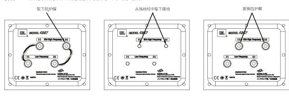
若您使用单个立体声功放进行双线分音,请按下图所示连接扬声器。
