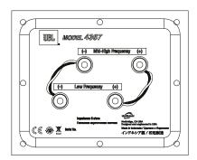
Конструкция модели 4367 разработана таким образом, чтобы положительное напряжение на клемме «+» (красной) вызывало перемещение преобразователей колонок наружу (по направлению к помещению).
