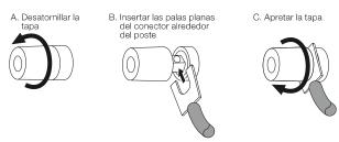
IMPORTANTE: Asegúrese que las patillas planas de los conectores (+) y (-) no se toquen entre si o con el otro terminal. Si se tocan las palas, se puede provocar un cortocircuito capaz de dañar el amplificador o el receptor.
