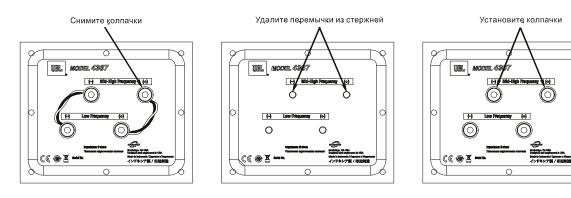
Если вы двумя проводами подключаете колонки к одному стерео-усилителю, выполняйте подключение в соответствии с рисунком ниже.
