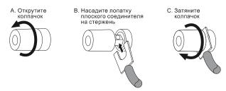
ВНИМАНИЕ: убедитесь, что лопатки плоских соединителей (+) и (-) не касаются друг друга или других клемм. В противном случае может произойти короткое замыкание, которое может повредить ресивер или усилитель.
