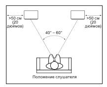
Для получения оптимального звучания размещайте колонки на расстоянии двух-трех метров (от 6 до 10 футов) друг от друга. Если вы устанавливаете колонки на большем расстоянии друг от друга, направляйте их в сторону слушателя(-ей).
