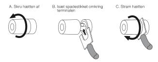
VIGTIGT: Sørg for, at spadestikkene (+) og (-) ikke kommer i kontakt med hinanden. I modsat fald kan der opstå kortslutning, som kan beskadige receiveren eller forstærkeren.
