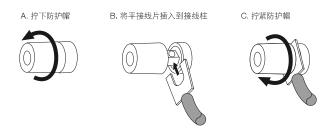
重要信息:请确保(+)和(-)平接线片没有互相接触或接触到其他端子。接线片互接会导致短路,令接收器或功放受损。
