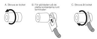
VIKTIGT: Se till att (+)- och (-)-bladen på de platta kontakterna inte vidrör varandra eller den andra terminalen. Kontakt mellan bladen kan orsaka kortslutning som kan skada receivern eller förstärkaren.
