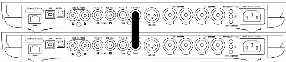
Per configurare il vostro sistema in modalità Dual-Mono, collegate ciascun diffusore ad un amplificatore e connettete i due amplificatori con un cavo digitale (S/PDIF o S/PDIF-AES/EBU).
