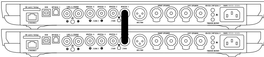
Para configurar su sistema en modo Dual-Mono, conecte cada altavoz a un dispositivo y conéctelos entre ellos por medio de un cable digital (S/PDIF o S/PDIF-AES/EBU).
