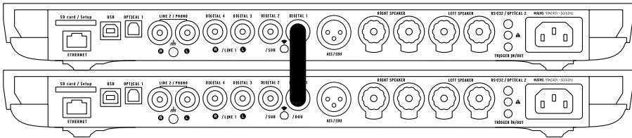
为您的系统设置双-单声道模式，请将扬声器连接到设备上，并用光纤电缆（S/PDIF或S/PDIF-AES/EBU）连接所有设备。
