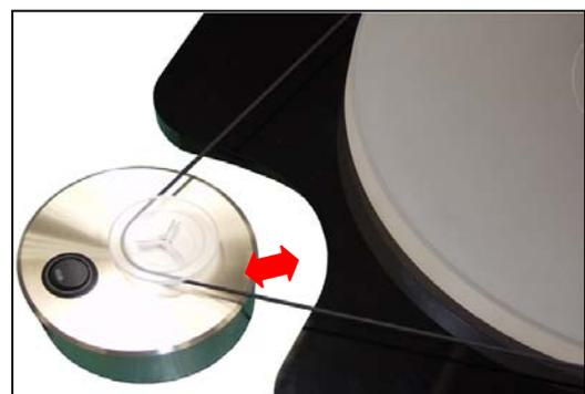
5. Spannen Sie den Antriebsriemen um den Plattenteller und das Antriebsrad. Verwenden Sie für 33 1/3 U/min den kleineren, für 45 U/min den größeren Durchmesser des Antriebsrads.
