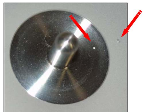
3. Stecken Sie das Plexiglas-Antriebsrad auf die Achse des Motors. Die Unterseite des Antriebsrades sollte ca. 1-2mm von der Motorblockoberfläche entfernt sein. Bitte ziehen sie die Madenschrauben mit Hilfe des mitgelieferten Schraubenziehers fest.
