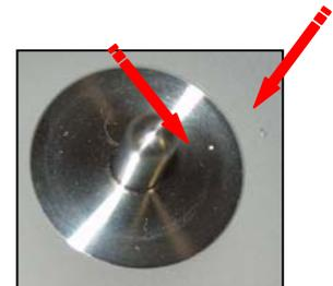
Abbildung 2: Richtige Positionierung des Lagers
