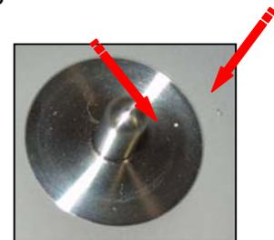
Abbildung 2: Richtige Positionierung des Lagers
