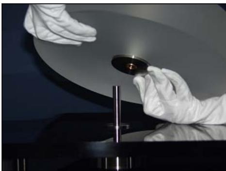
Abbildung 1: Aufsetzen des Plattentellers auf dem Lager
