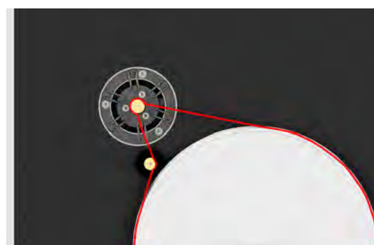
Abb. 3: Auflegen des Riemens
