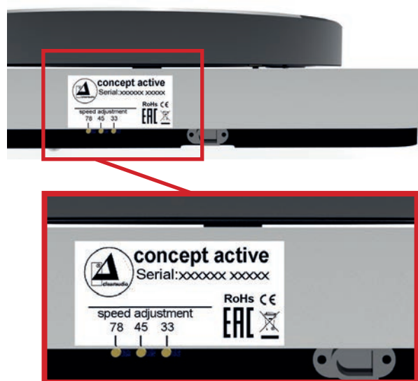
Abb. 11: Platzierung der Trimmer
