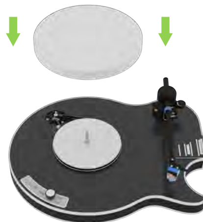
Abb. 5: Aufsetzen des Plattentellers
