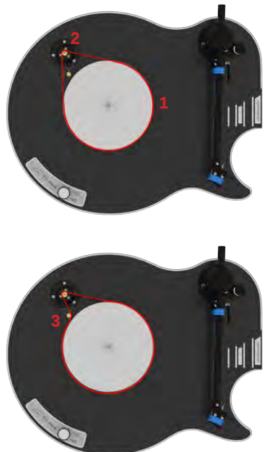
Abb. 4: Auflegen des Riemens
