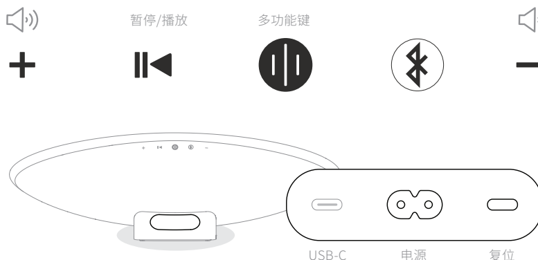
图一 Zeppelin Pro Edition 控制面板和连接口
