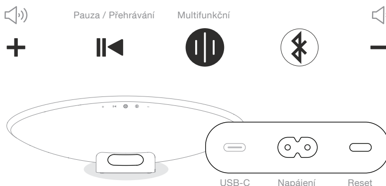
Obrázek 1 Zadní panel a ovládací prvky Zeppelin Pro Edition
