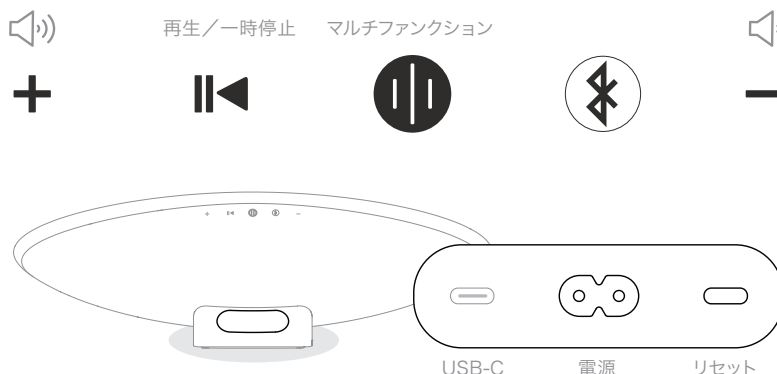
図1 Zeppelin Pro Edition 操作パネル/接続端子
