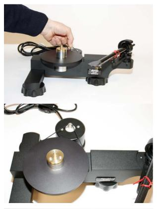
• FIT THE DRIVE BELT BY LOOPING OVER THE DRIVE HUB, THEN STRETCHING OVER THE DRIVE PULLEY.
